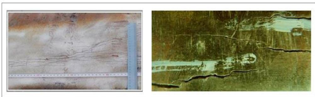
Рисунок 1 - Проявления коррозионного растрескивания под напряжением на газопроводе
